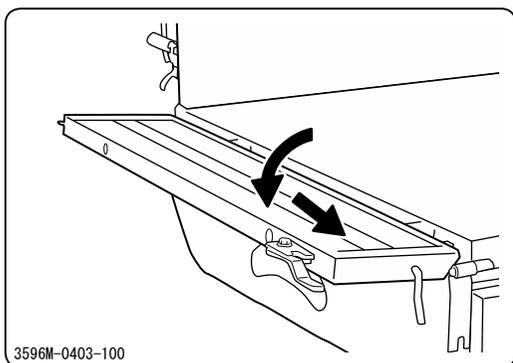
4 側板を水平位置、または斜め位置まで倒し、前方にスライドし固定します。
