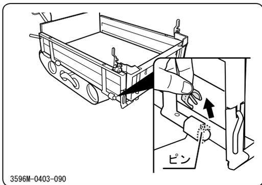
3 側板を固定しているピンを抜きます。
