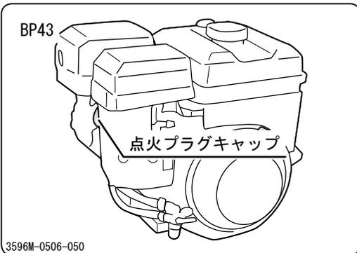
**4** 点火プラグキャップ、点火プラグを取り付け、荷台を下降させます。
