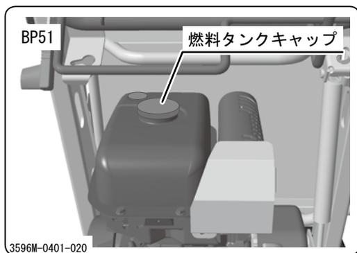
**3** 燃料タンクキャップを確実に閉めます。
