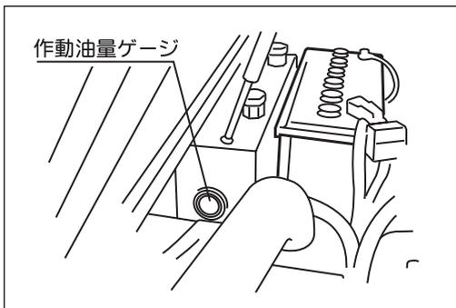
2. 作動油量ゲージにてオイル量を目視点検し、オイルが不足している場合は、オイルを補給します。
