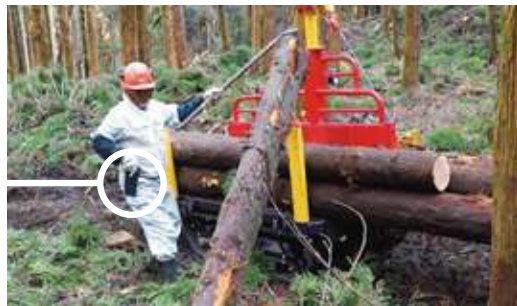
ラジコンウインチで簡単木寄せ キャニコム独自のHST正転・逆転 ラジコンウインチを採用。
