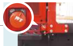
緊急停止スイッチ 後進時に万が一 挟まれそうになった場合 スイッチひと押しで エンジンを停止させます。
